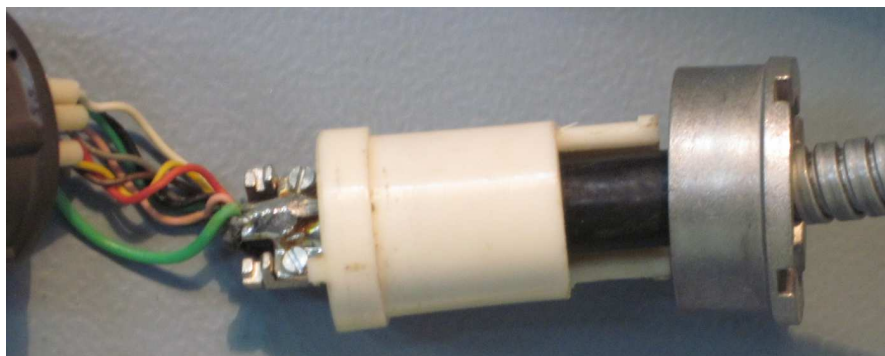
Рис. 4. Цветная маркировка проводов разъема РС10ТВ.
